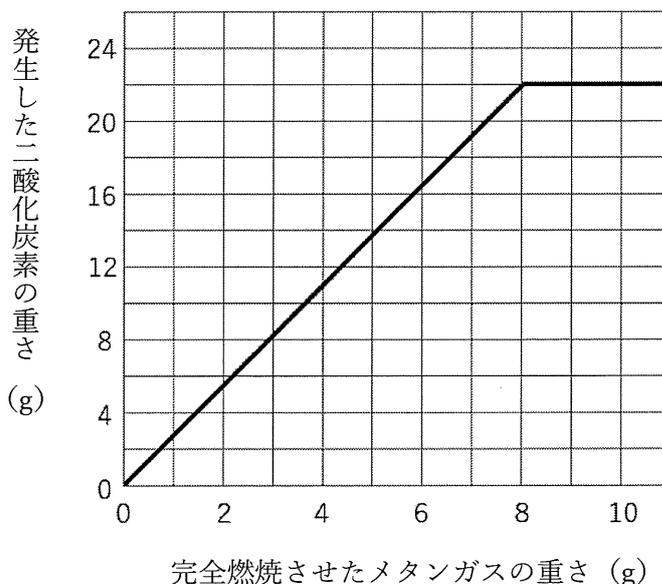
図2 メタンガスを完全燃焼させたときに発生した二酸化炭素の重さ
